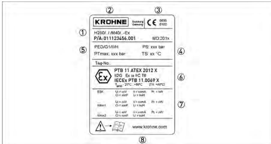
Рисунок 2-2: Типовая табличка на индикаторе
